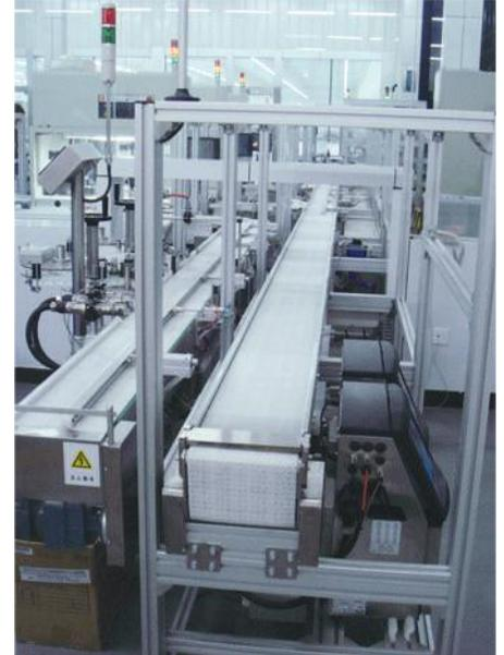
Transportador de Cadena Plástica con Borde tipo Cuchilla
